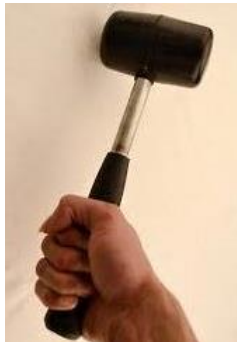
4. Ayuda a compactación del material
